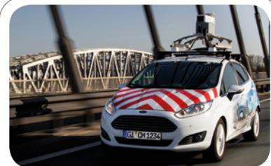
Mit diesen Autos erfasst Cyclomedia die Daten – mit einer Geschwindigkeit von bis zu 120 km/h.
